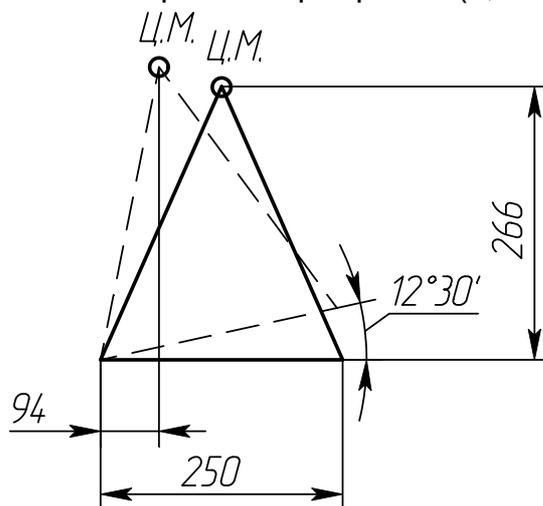
Рисунок 1- Схема устойчивости электронасосного агрегата типа ЦНСп 2,5
